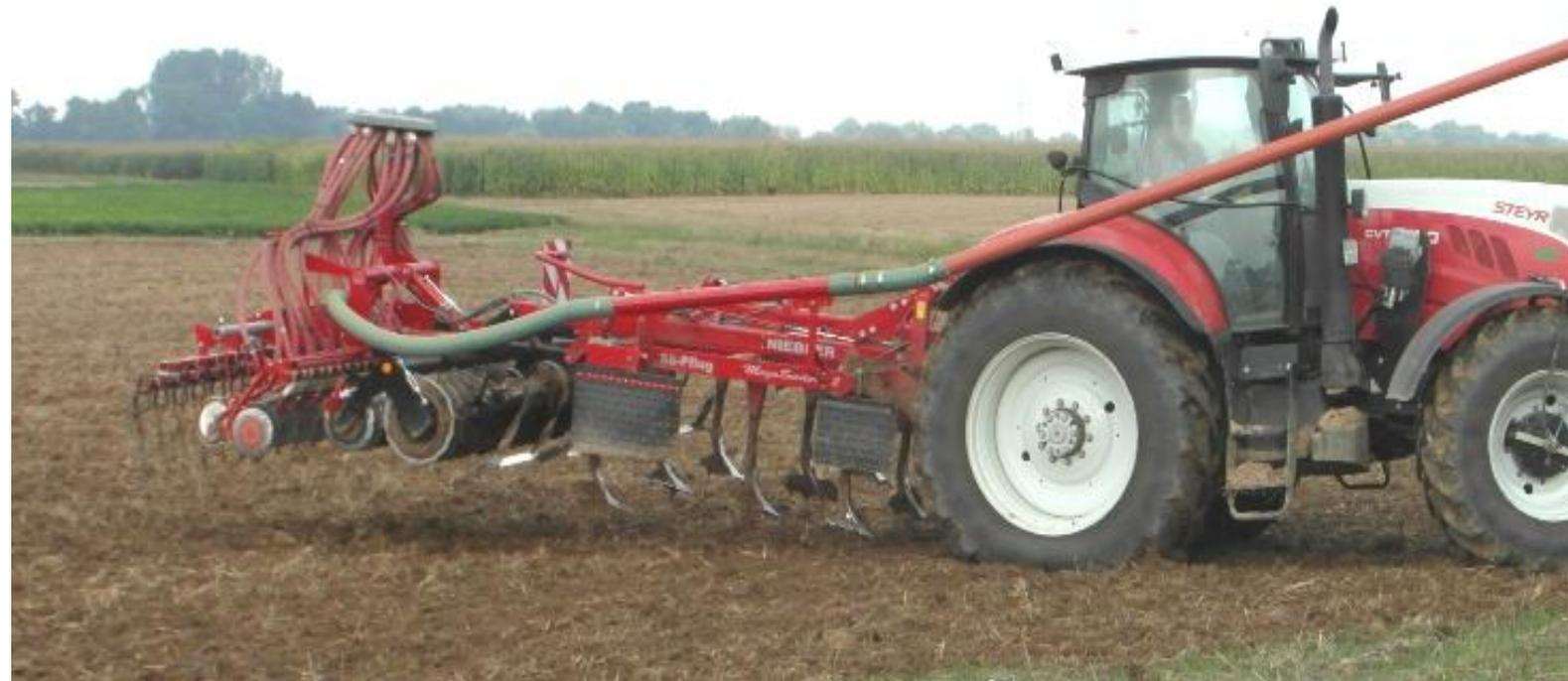
Stabile verschleißarme und nachschmierbare Einscheibenschare mit Hartmetalleinlage, extra große Lager für 500.000 km ausgelegt, verschleißfreie Scharführung mit Tiefenbegrenzung 410er Scheiben, langer Scharschritt für störungsfreies lauffähiges Säen auch bei viel Mulch, deshalb auch 12,5 cm Reihenabstand; Für sehr klebrige Böden sind Abstreifer nachrüstbar.
