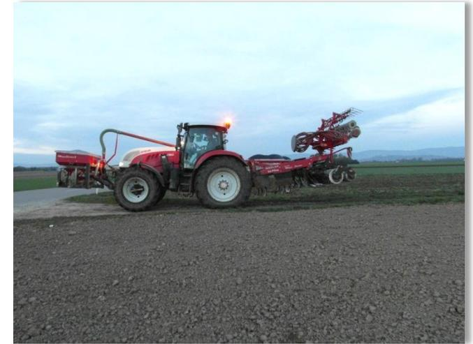
2 gut dimensionierte feinfühligere Hydraulikzylinder mit Sperrblock schwenken die Säeinheit zügig von Transport- in Arbeitsstellung und genauso wieder in Transportstellung.
