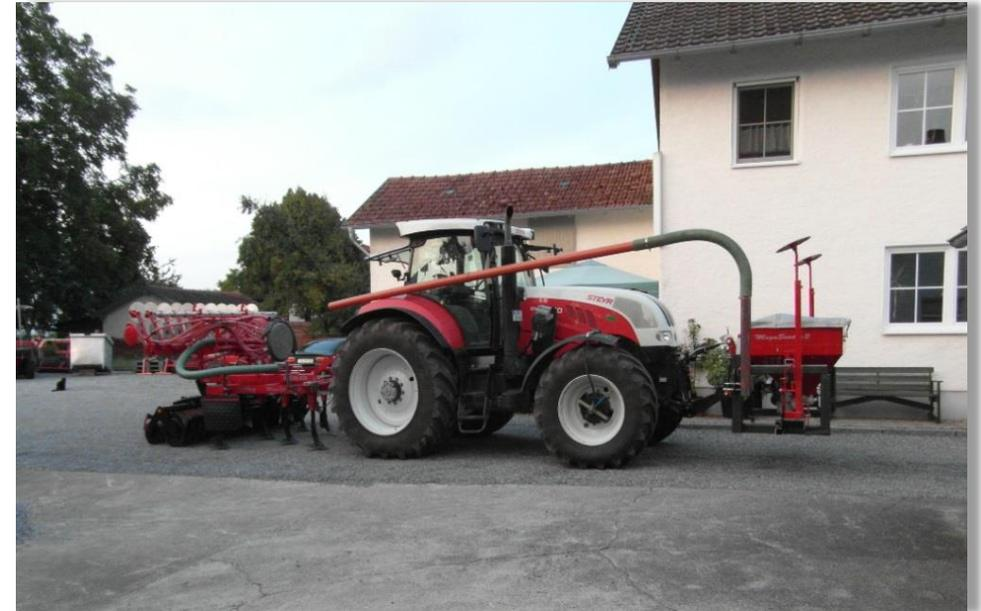
Großer Säbunker für ebenerdiges bequemes Befüllen, Abdrehen und Entleeren.
